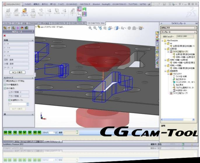
CG PressDesign/CG MoldDesign で設計されたモデルから、ワイヤのNCデータを自動作成する一貫した操作性！！
