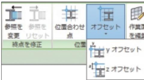
新しい機能により、構造フレーム要素の的確な定義と配置が可能になりました。結合された梁の終点を別の梁や構造柱、構造壁等任意の位置への変更が行えます。以前に位置合わせした梁の端点をリセットすることができます。作図領域内の梁やブレースの終点延長やカットバックをクリックしてドラッグするのに、形状ハンドルが使用できるようになりました。フレーム要素ジオメトリを直接操作し、終点を他のジオメトリや参照線にスナップするには、形状ハンドルを使用します。[オフセット y] や [オフセット z] 位置合わせツールを使用して、フレーム要素の物理的ジオメトリを簡単にオフセットできるようになりました。パラメータ値を手動で計算してプロパティパレットに入力することなく、作図領域で直接に微調整ができるようになりました。モデリング中に、梁とブレースの位置基準を任意のビューに参照として表示します。
