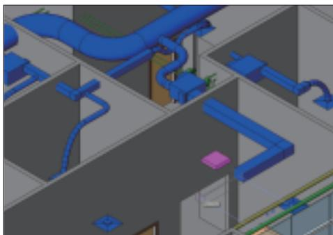
カスタムのダクトおよび配管システムのタイプを作成して、名前を付けることができます。色、線の太さ、線種パターンなどグラフィックスの上書きのプロパティを特定システムのオブジェクトに利用できます。システム設備に接続しなくても、システムにオブジェクトを割り当てできます。システム省略形を使用してシステム ジオメトリに注釈を付けられます。
