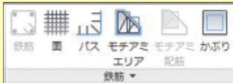
コンクリート部材に配筋を追加します。壁や床などサーフェス要素から作成されたコンクリート部材にはかぶり厚があり、鉄筋、鉄筋セット、面の配筋、パス配筋、モチアミ配筋をホストすることができます。
