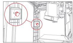
3.レンズの周囲のプラスチックリングを掴んで、 少し回します。カメラのレンズには触れないでください。
