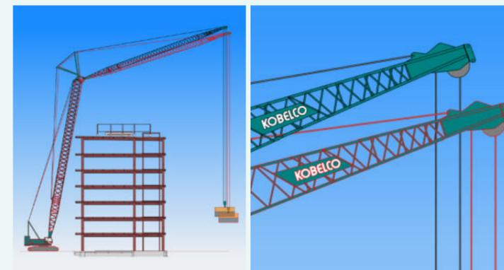
巻き上げで地切りした際のジブ先端の移動量のシミュレーション結果を表示させることが可能です。負荷に応じてアタッチメントが傾斜し、吊り荷が動きます。狭小地など、クレーンと構造物との干渉のリスクが高いシーンでご活用ください。
