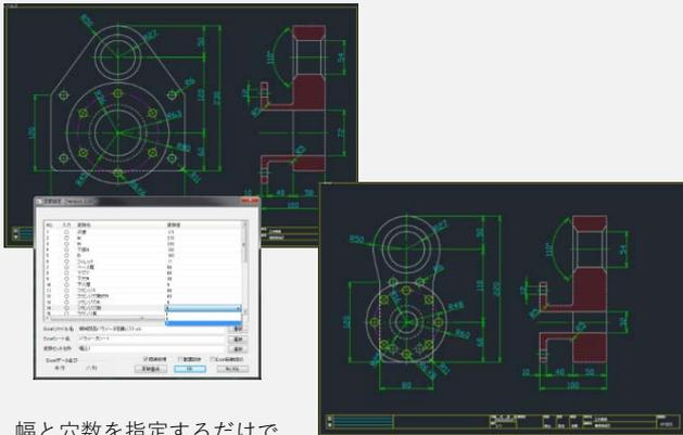
幅と穴数を指定するだけで図形が動き出し、一瞬のうちに完成図面が出来上がる
