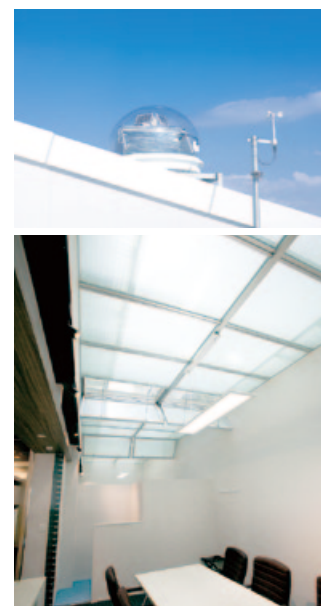
太陽追尾型採光装置により、自然光を最大限に採り入れることができる
